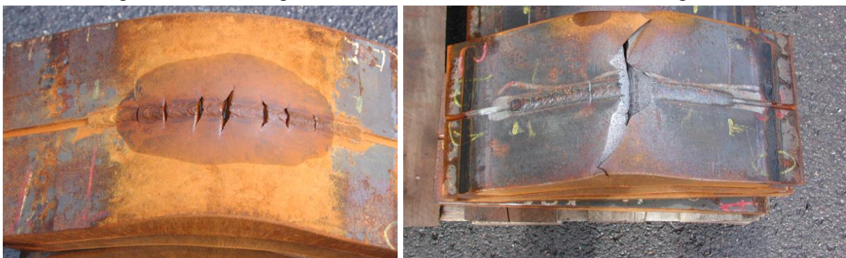
Bild 1-1: Makroaufnahme nach Aufschweißbiegeversuch; Prüfergebnis a) bestanden und b) nicht bestanden
